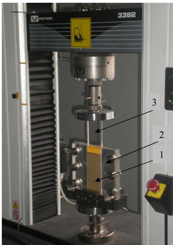
Рис.1. Стенд для проведения испытаний: 1 – образец; 2 – матрица; 3 – пуансон
