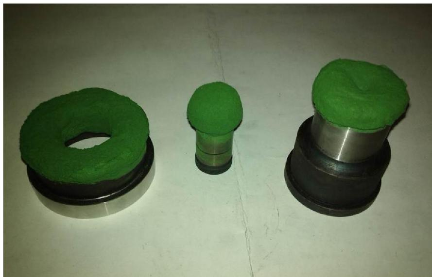
Рис. 2. Изделия после нанесения обмазки
