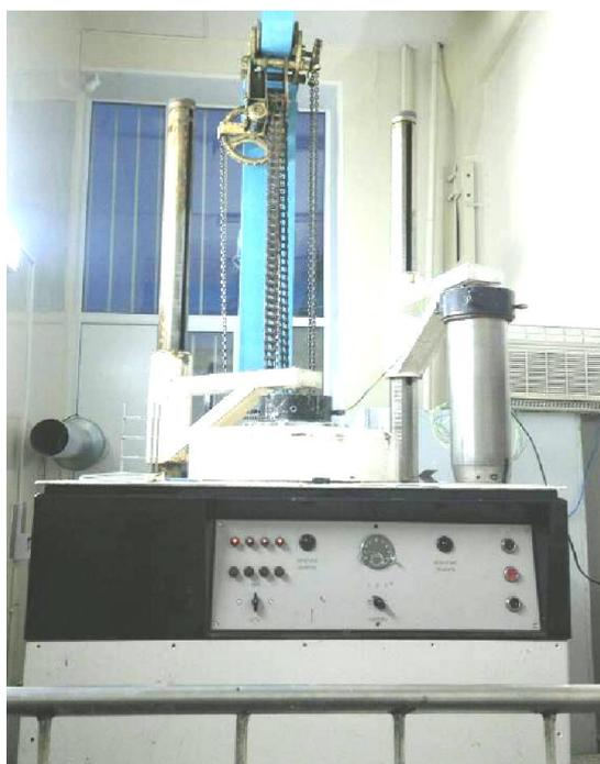
Рис. 1. Гамма-установка «Исследователь» на изотопе  $\text{Co}^{60}$
