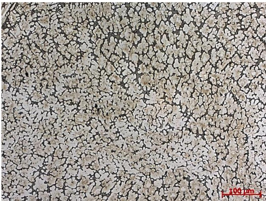
Рис. 2. Микроструктура покрытия, полученного при наплавке с током пучка 24 мА.
