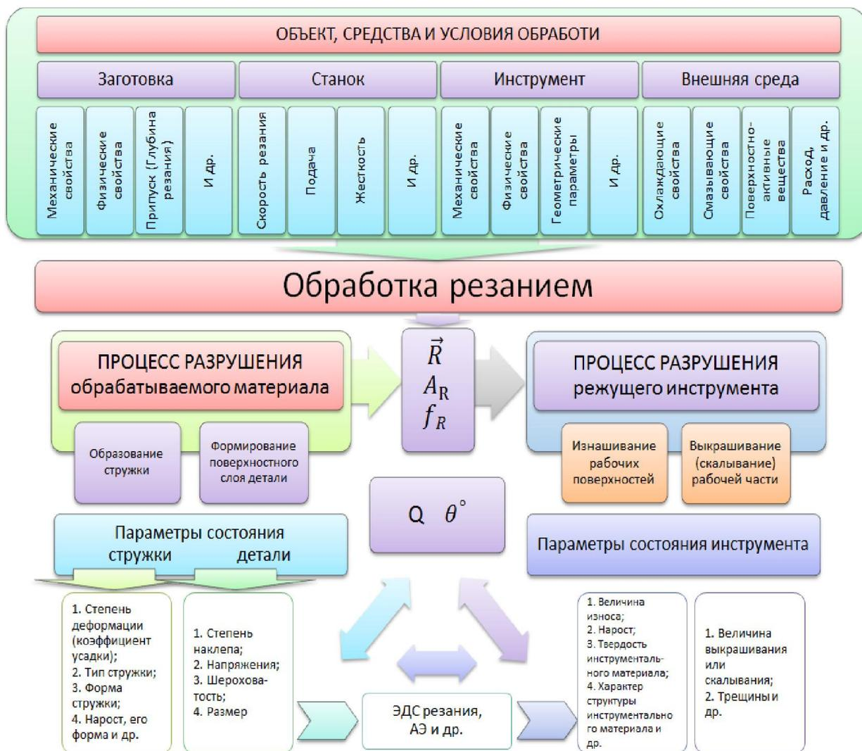
Рис. 2. Взаимосвязь параметров в процессе резания
