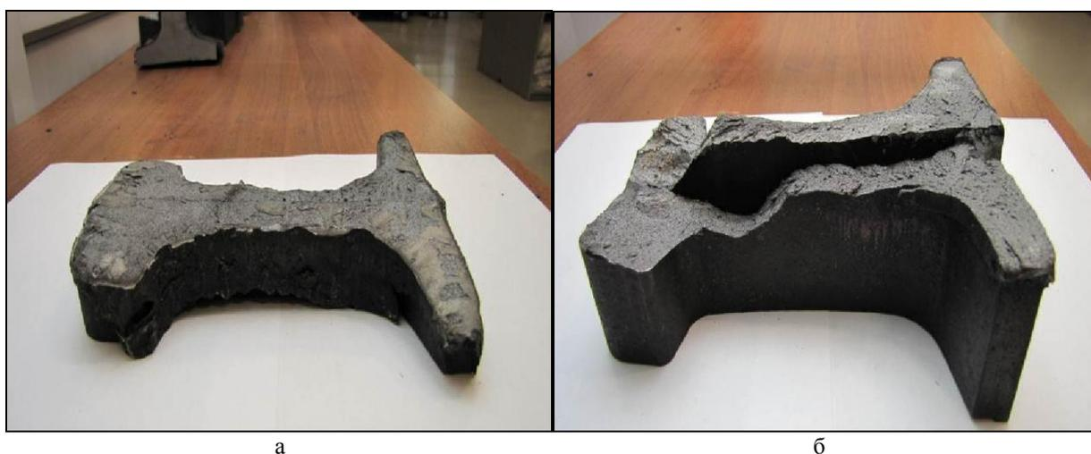
Рис. 5. Излом сварного соединения со вставкой 20 мм (а) и 5 мм (б) после испытаний по схеме трехточечного изгиба.
